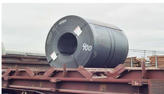
Figure 5 : Coil (bobine) en sortie du laminoir, non cisillée, non refendue
