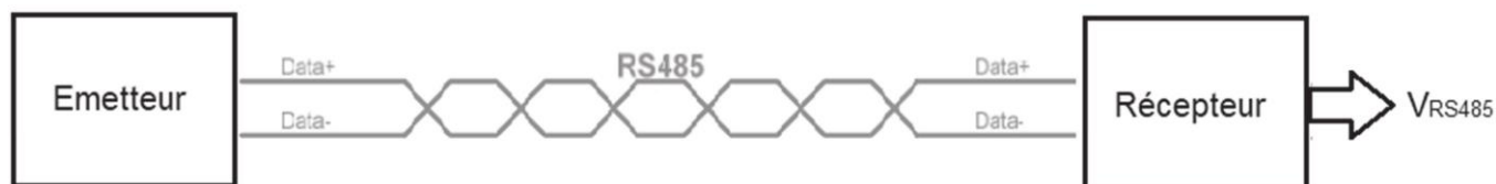
Figure 1: schéma de liaison norme RS-485
